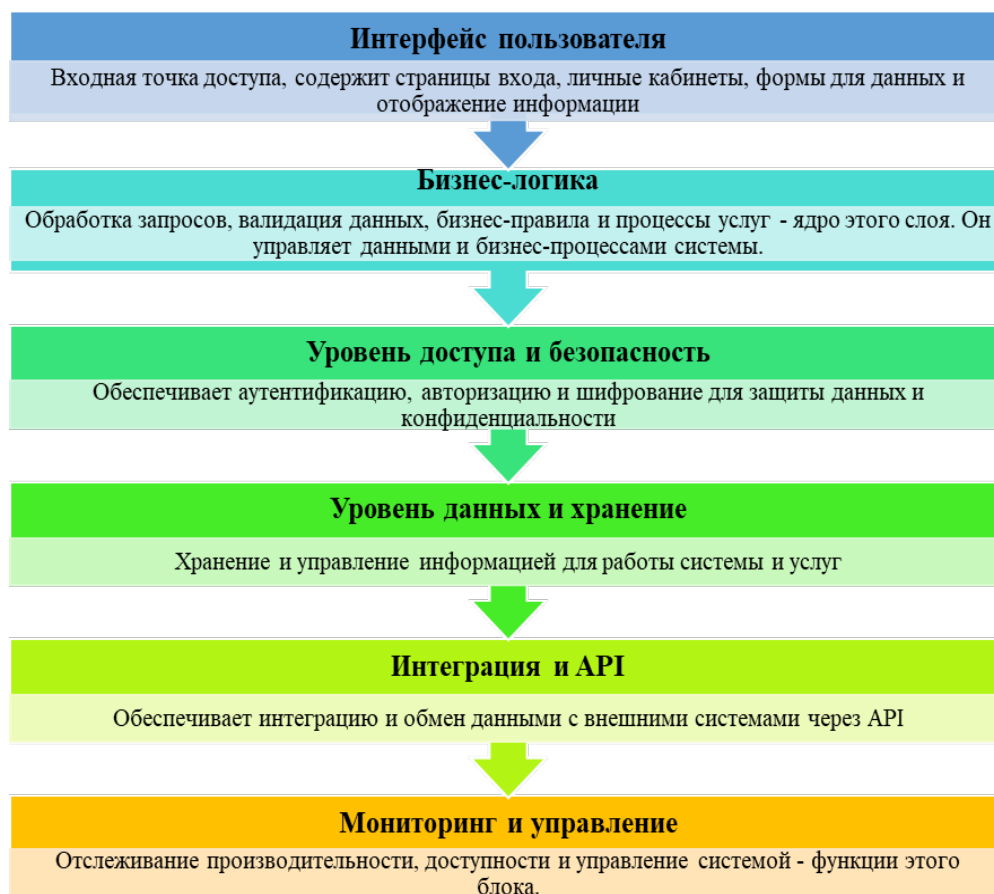
Рисунок 4 – Блок - схема архитектура портала ГИС
