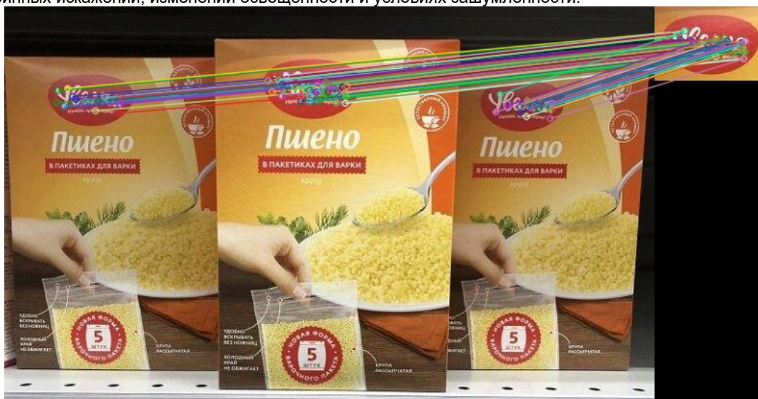
Рис. 5. Пример сопоставления особых точек на изображении фрагмента выкладки.
