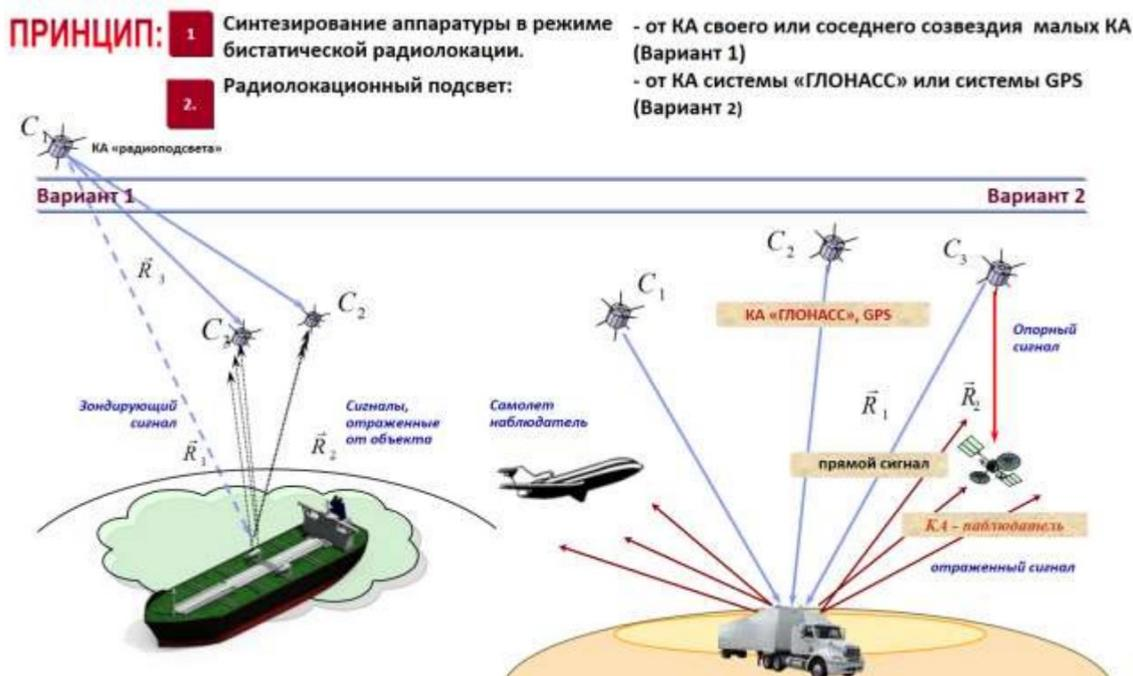
Рисунок. 4. Кластер МКА бистатического радиолокационного мониторинга «РАДИОЛОКАТОР»
