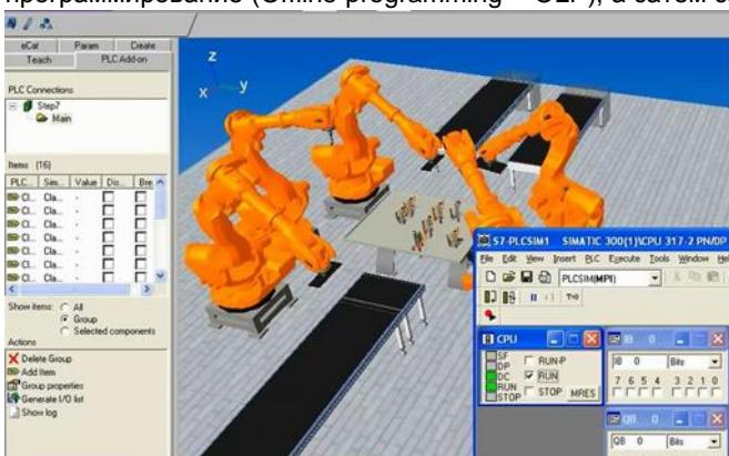
Рисунок 7 Оффлайн-программирование и отладка в цифровом двойнике
