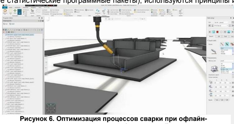
Рисунок 6. Оптимизация процессов сварки при оффлайн-программировании в цифровом двойнике
