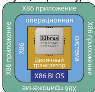
Обеспечивает исполнение ОС: MS DOS, Windows (95, NT, 2000, XP), нескольких вариантов Linux, FreeBSD, QNX
